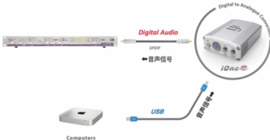
音楽ファイルがたくさん入ったノートパソコンから高品質なDACにデータを送りたいと思った時、それらのDACが高品質なUSB入力を備えていないことがよくあります。nano iONEのS/PDIF接続を出力用に使用すれば、Bit-Perfectのデジタル信号をUS\$10000のDACにさえ送ることができ、すばらしい高解像度のオーディオ再生が実現します。nano iONEのUSB入力にノートパソコンを接続し、S/PDIF出力経由で信号を「取り出し」、DACのS/PDIF入力に送る…これで完了です。非常に真摯なオーディオファイルも、nano iONEを加えるだけで、コンピューター・ソースからお手持ちのきわめて豪華なホーム・ステレオ・システムに音楽を伝送することができます。24bit/192kHzまでのフル高解像度のサポートとJET (ジッター除去テクノロジー)、そしてさらにガルバニック・アイソレーション (絶縁) を施されたS/PDIF出力の組み合わせによって、nano iONEはどのようなオーディオファイル・システムにとっても、ほんもののソースとなるのです。
