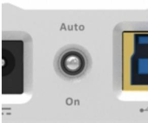
新しいnano iUSB3.0は、Auto/On USBパワー・ライン・オプションを提供し、いっそうの使用の便宜を図っています。このスイッチをOnにしておくと、nano iUSB3.0は5Vの電力を供給し続けます。つまり、DACが接続されていることをコンピューターが常に認識し、接続を認識しなくなる（電源のOff/Onが正しい手順で行われない時に接続が認識されなくなることがあります）ことがないということです。
