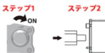
iDSDのスイッチをオンにしてから(ステップ1)USBケーブルを接続します(ステップ2)。
