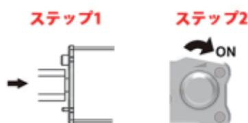
先にコンピューターに接続したUSBケーブルとiDSDを接続してから(ステップ1)iDSDの本体スイッチをオンにします(ステップ2)。
