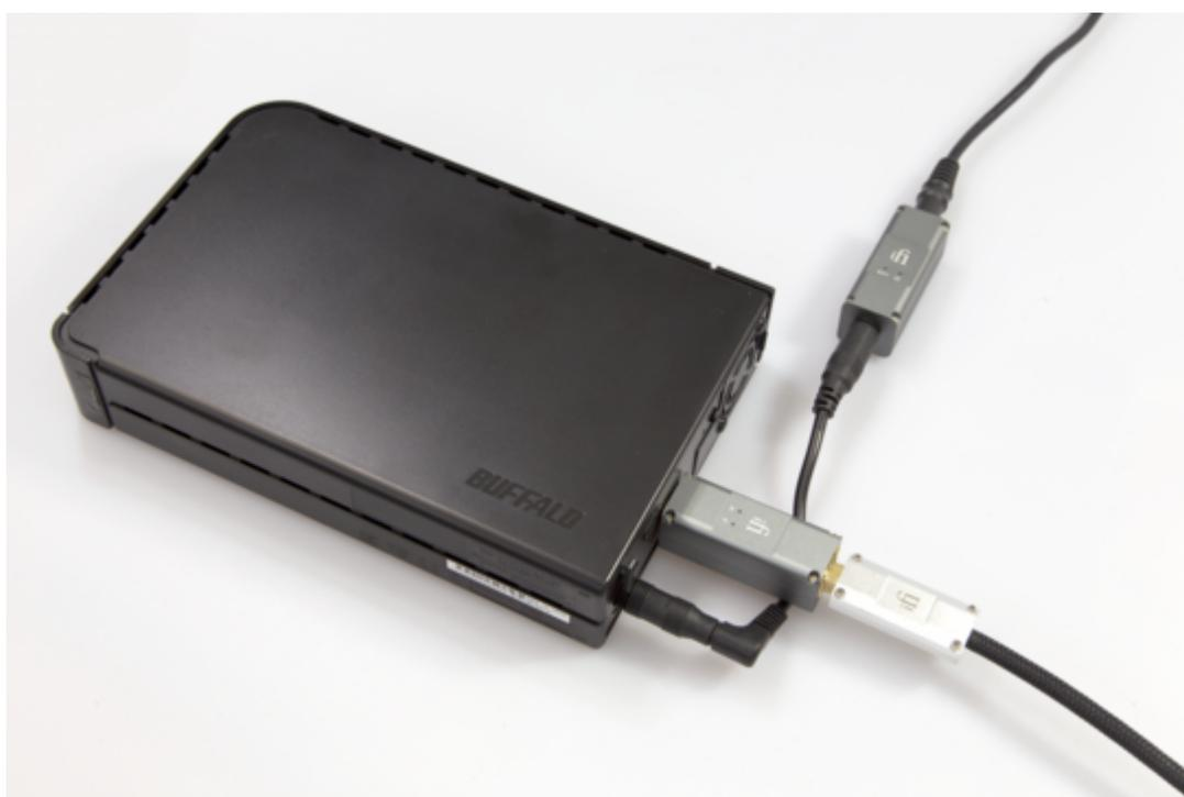
外付けHDDにiPurifier DCとiPurifier2を接続
